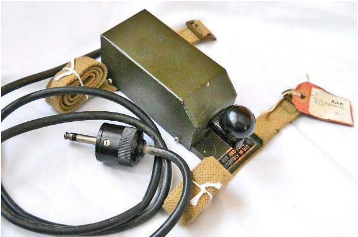
Key and Plug Assembly No. 9AT ver. 4.2.
