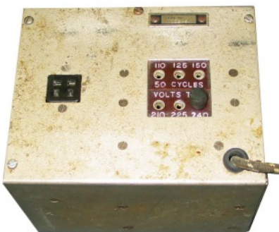
AC mains power unit.
