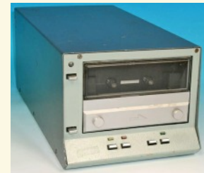
Cassette erase and rewind unit CAG-U (German U = Umspül und Löscherät)
